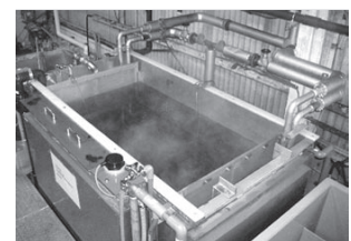
無電解ニッケルめっき槽
