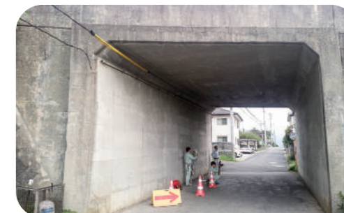
クラックスケールを内蔵した光波測量器での測量の様子
