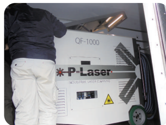
レーザークリーニング装置での作業様子
