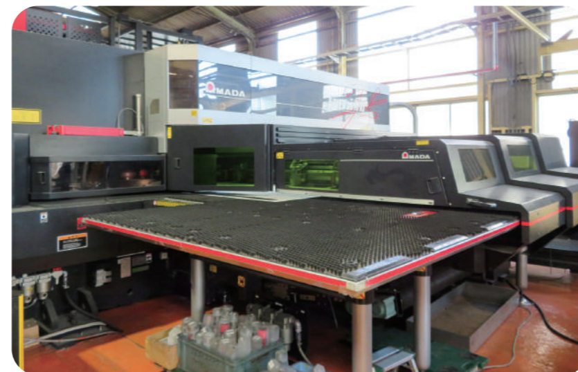
3D-CAD/CAMシステム、ファイバーレーザー複合機、インバータ溶接機の導入で「IoT化による複数加工設備の操作制御」が可能で新生産システムを構築
