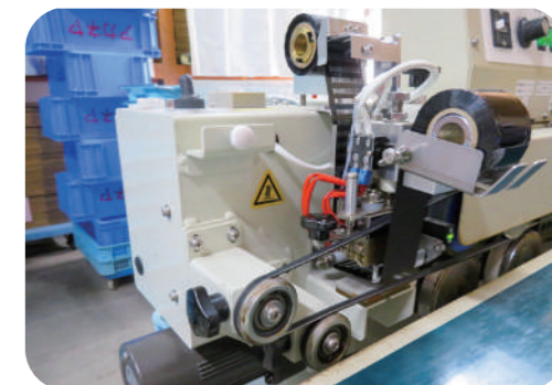
ヒートプリンターで袋に直接賞味期限を印字することで作業時間を短縮
