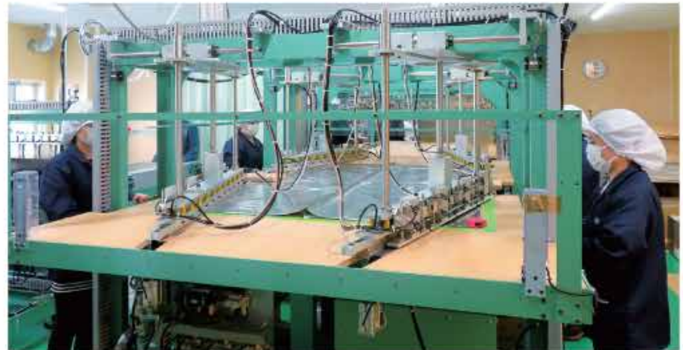
高機能アルミラミネート袋・大型半自動製袋装置。
