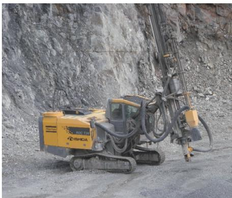
火薬を入れるための穴を掘る機械 (穿孔機クローラー)
