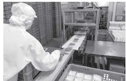
新たな商品検知システム「パッケージリークテスター」
