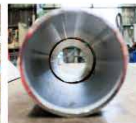
パイプ内面に継ぎ目ができないようにする「裏波溶接」
