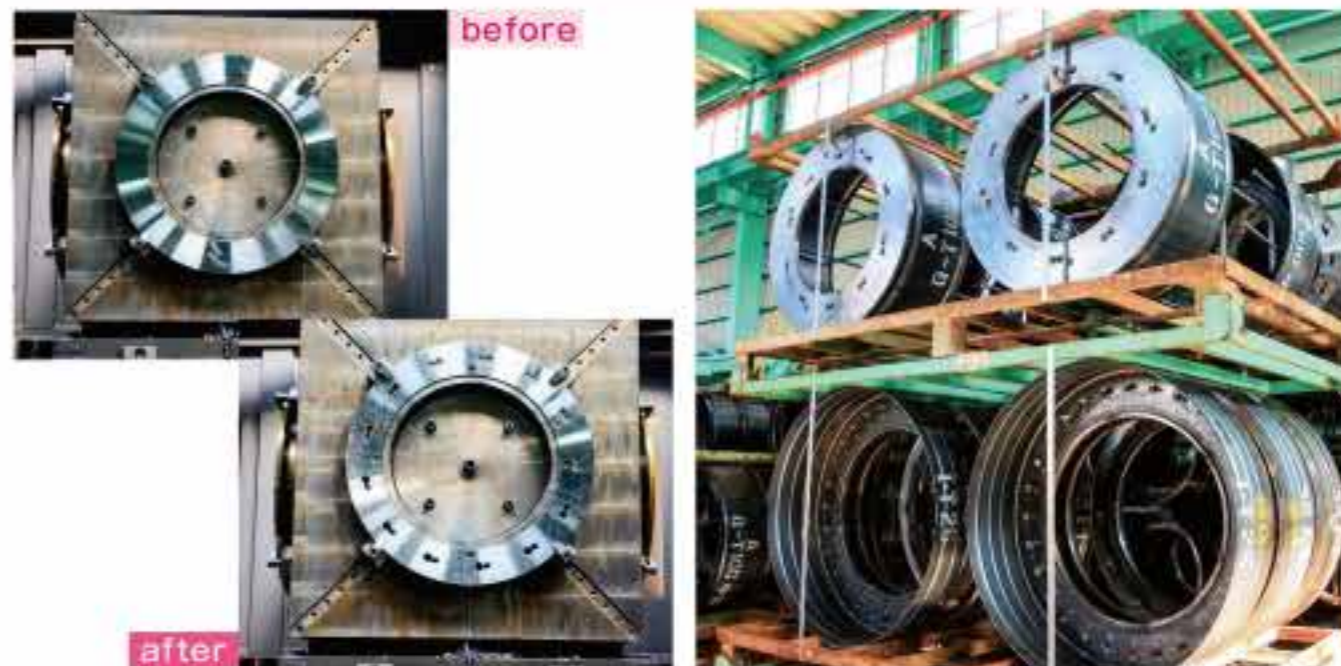
最新のマシニングセンターでフランジの穴開け 完成品、全国各地に発送されます。
