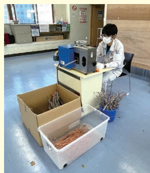
機器使用による廃棄電線の分離作業の様子
